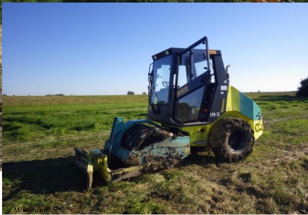
«Pied-de-mouton» pour le tassement de matériaux terreux
